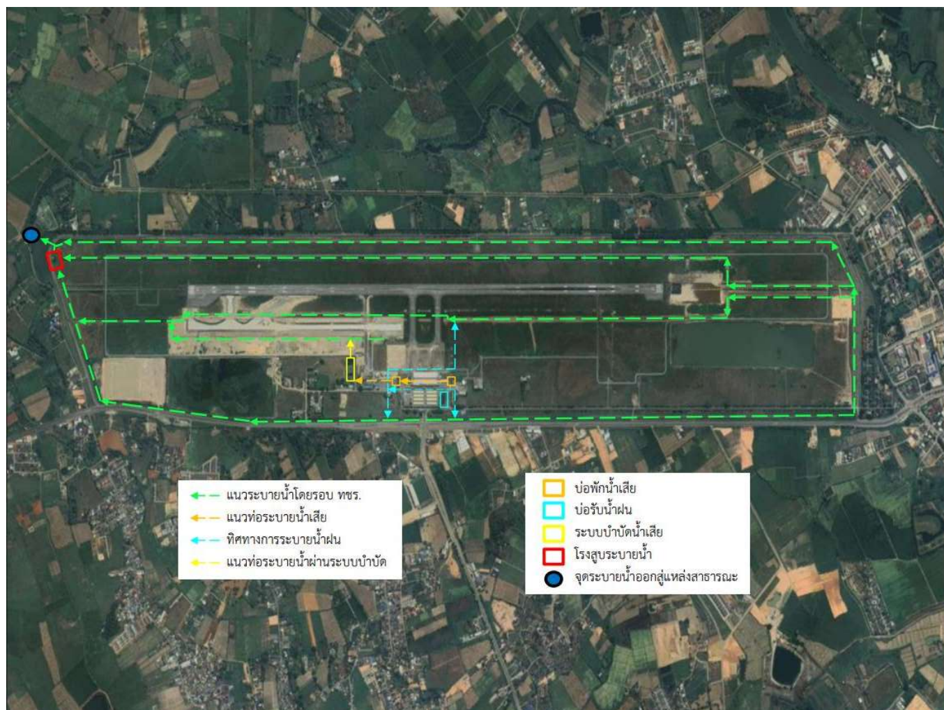
รูปที่ 2-10 แนววางระบายน้ำของ ทขร.
